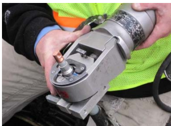
Şəkil 4. İnjesiya prosesində istifadə olunan adapter və birləşdirici
