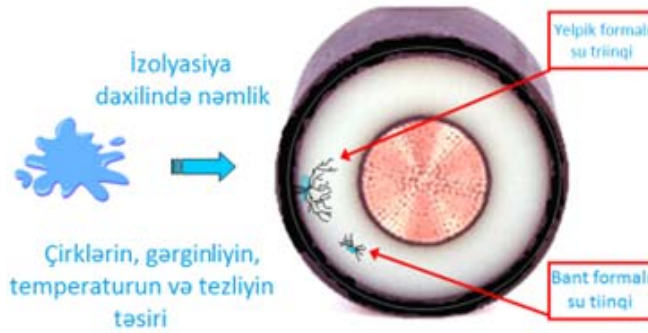
Şəkil 1. İzolyasiya meydana gələn su triinqləri
